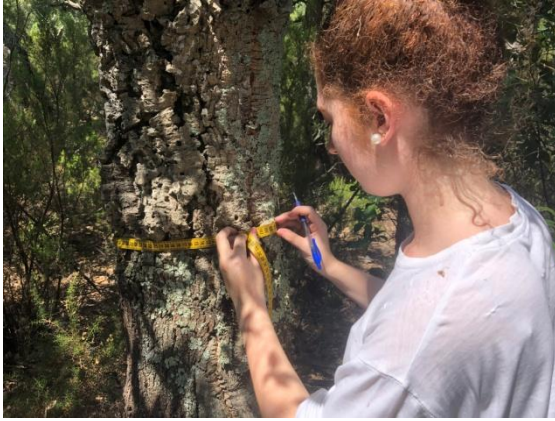
Il·lustració 50. Mesura del perímetre del tronc amb la cinta mètrica d'1,5 metres. Font: Elaboració propia.
