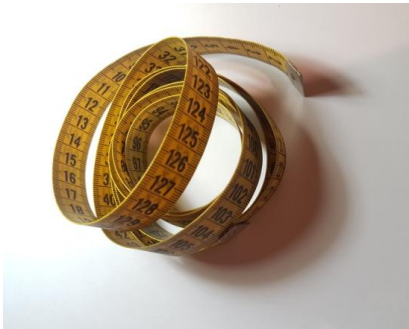
Il·lustració 57. Cinta mètrica de 1,5 metres. Font: Elaboració pròpia.
