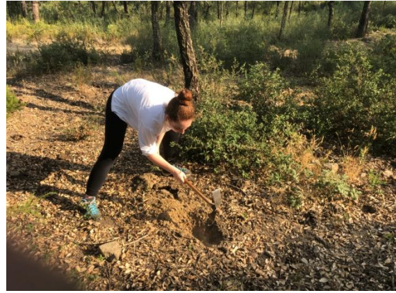
Il·lustració 51. Cavant el sòl amb el magall per a la mesura posterior del gruix de l'horitzó O. Font: Elaboració propia.
