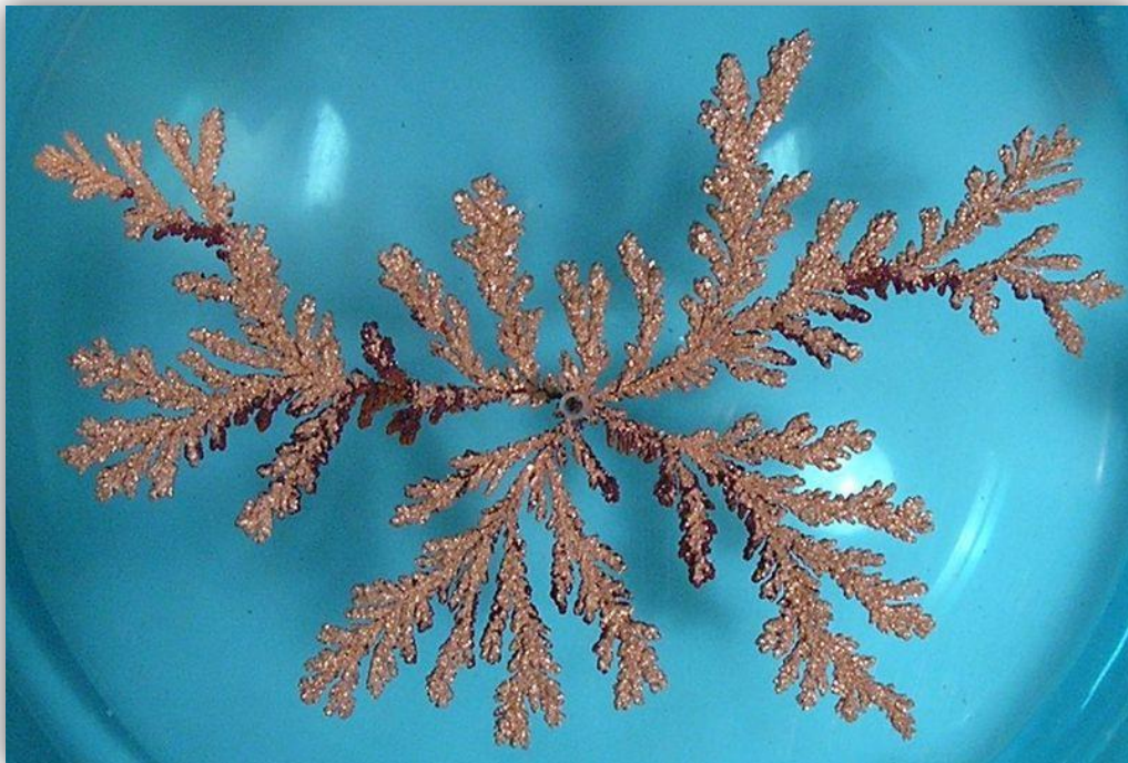
Estructura DLA generada per una solució de sulfat de coure en una cèl•lula de electrodepositació
